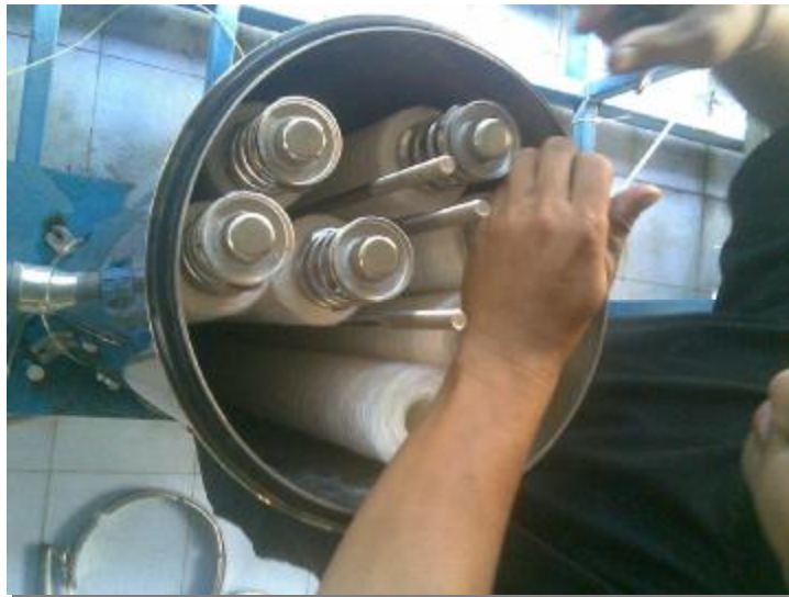
มีการใช้เครื่อง RO ในการปรับสภาพน้ำก่อนการจ่ายเข้าไปในระบบ
