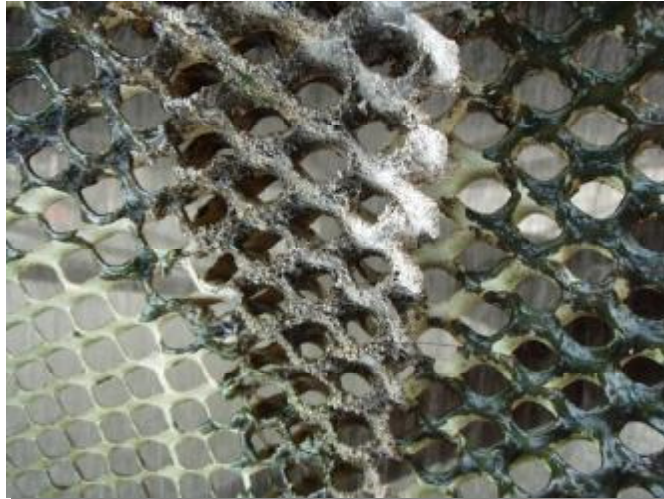
มีการเกาะของตะกรันอยู่ทั่วไปทั้งภายในและภายนอกและหนาแน่นในบางพื้นที่
